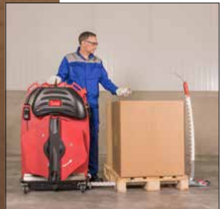
... la chaîne lance feillard guide le feillard sous la palette ...
