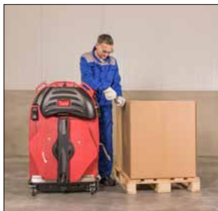
La chaîne amène la seconde extrémité du feuilard.
