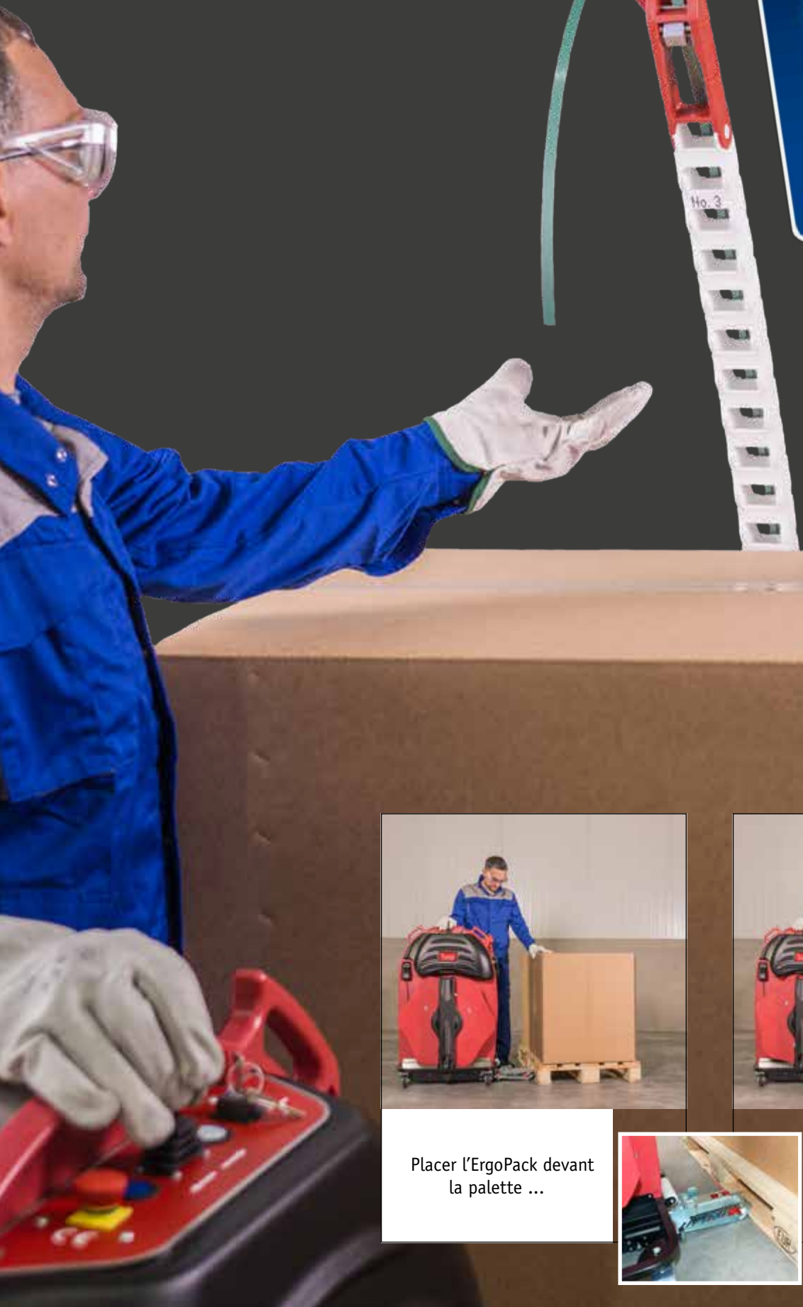
... la chaîne lance feillard guide le feillard sous la palette ...
